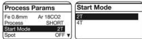
**2T**- Svařovací proces se spustí po stisknutí tlačítka hořáku a ukončí svařování pokud je tlačítko uvolněno.
